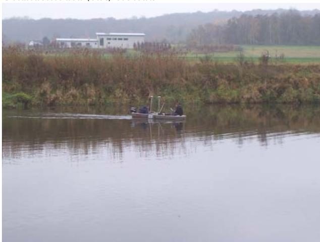
Die notwendigen Vermessungsleistungen zur Aufnahme von Sohl- und Vorlandhöhen sowie 2d-Geschwindigkeitsverteilungen und querschnittsbezogenen Durchflüssen erfolgte mittels D-GPS (Global Positioning System), Peillot und Grande ZedHed Acoustic Doppler Current Profiler (ADCP).
